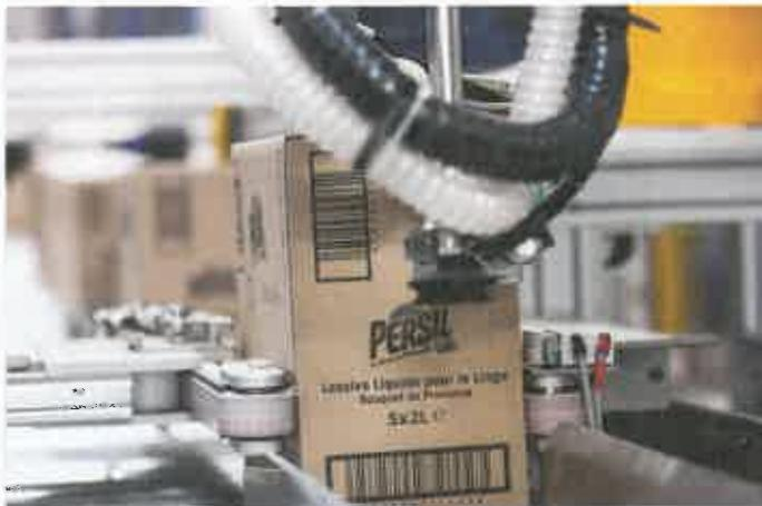
Le module MDC 400 conçu par le service automatisation de FM Logistic et Axys Robotique est capable de découper des colis à différentes hauteurs sans risque pour le contenu. (© D. Delion)
